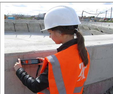
Рис. 12 Измерения прибором RESIPOD в натуральных условиях
