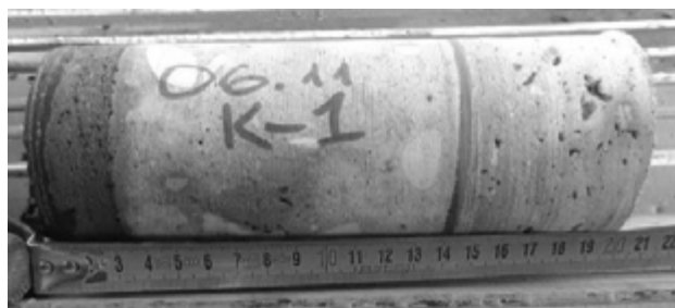
Рис. 3. Керн № 1, выбуренный из купола на укрепленном участке
